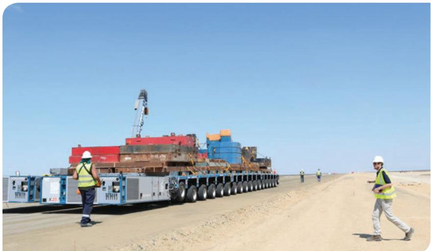
Illustration 4 - Remorque utilisée pour l'essai dynamique des remblais
