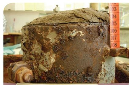
*Illustration 6 - Déchets d'acier provenant du remblai de la D47, à Ostrava (République tchèque), après essai de gonflement linéaire dans un moule CBR à une température de 75 °C*
