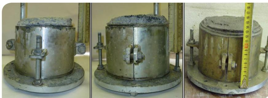
Illustration 4 - Échantillons de laboratoire de cendres volantes à l'issue d'essais de gonflement linéaire dans un moule CBR : cendres volantes de combustion en lit fluidisé (ETI), cendres résiduelles (ETI) et cendres volantes siliceuses (EME) après 28 jours de mûrissement sans liant
