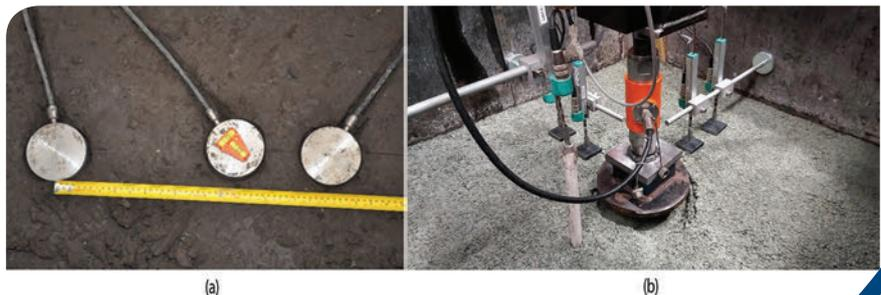
Illustration 4 - (a) Cellules manométriques dans le sol de fondation, (b) LVDT et charge à la surface
